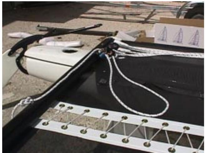
Fixer la poulie à l'aide d'une manille au crochet de grand-voile et attacher celui-ci au trou du milieu du point d'écoute. La poulie winch sera fixée à l'aide d'une manille sur le chariot qui se trouve sur la traverse arrière. Bien s'assurer que les poulies se font face. Prendre ensuite l'écoute de GV, passer une extrémité dans le pontet de la poulie winch et faire un noeud en huit, le circuit est ensuite le suivant
